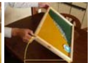
(d)底板を傾斜させて がけ崩れ発生
